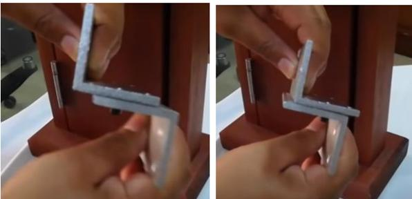
**Paso #13:** Utilizando la llave Allen proveída en el Kit apriete los 2 tornillos que sujetan la Montura A y B
