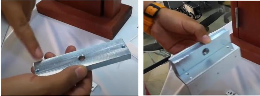
**Paso #15:** Atornille la placa de cierre a la Montura A utilizando el tornillo tipo estrella de cabeza avellanada incluido en el Kit. Es el tornillo corto de mayor diámetro de todos los tornillos del Kit. Asegúrese que la placa de cierre se puede mover libremente, no debe apretarlo, y debe verificar que la placa de cierre hace contacto con el electroimán. Es por eso que debe quedar el tornillo sin apretar completamente para permitir el movimiento hacia el electroimán
