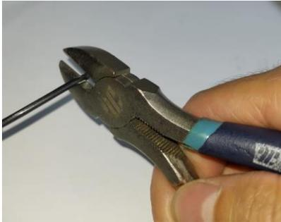
**Paso #21:** Remueve la cobertura del cable #18x6 color negro, cuide de no cortar el cable y descubra los hilos de cobre
