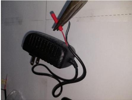
**Paso #24:** Debe unir el cable positivo del adaptador de corriente con el cable rojo positivo del magneto introducirlo por el acople (6) y usando el alicate de punta fina presione fuertemente para asegurar el cable.
