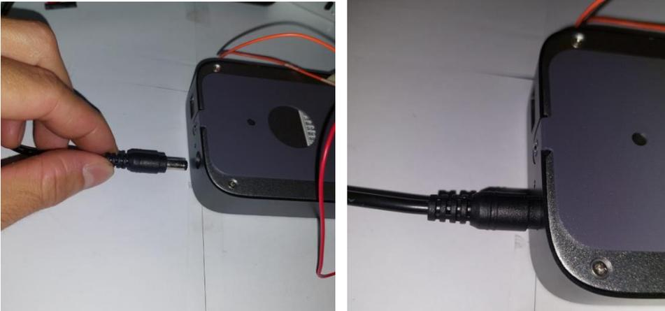
**Paso #39:** Conecte el cable de alimentación del adaptador del lector a la corriente alterna donde el voltaje sea 110v. **NUNCA** conecte el dispositivo un toma corriente superior a 110v, puede ocasionar una sobrecarga en el dispositivo y quemarlo. Asegúrese que esté bien conectado para evitar falsos contactos. Observará el lector que encenderá después de 5 segundos después de haberlo conectado.
