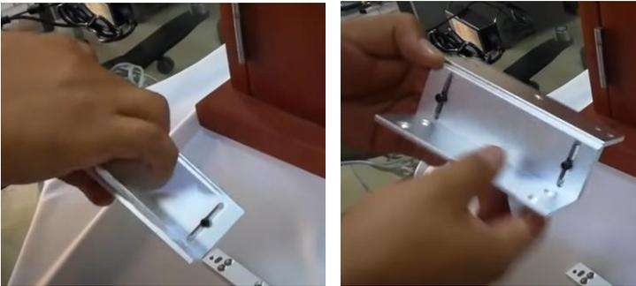
**Paso #12:** Asegúrese que puede deslizar las Monturas A y B entre sí en un movimiento hacia adelante y hacia atrás sin esfuerzo.
