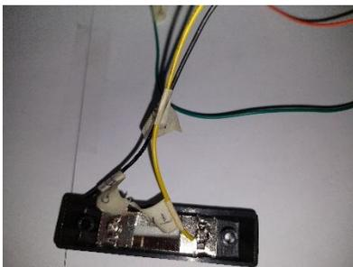
**Paso #29:** Asegure el cable con el destornillador de punta Phillips
